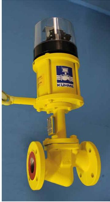
Abb. 9: Gas-Sicherheitsabsperreinrichtung: Vorher – Nachher
