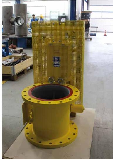
Abb. 11: Koksgas-Sicherheitsabsperreinrichtung Vorher – Nachher
