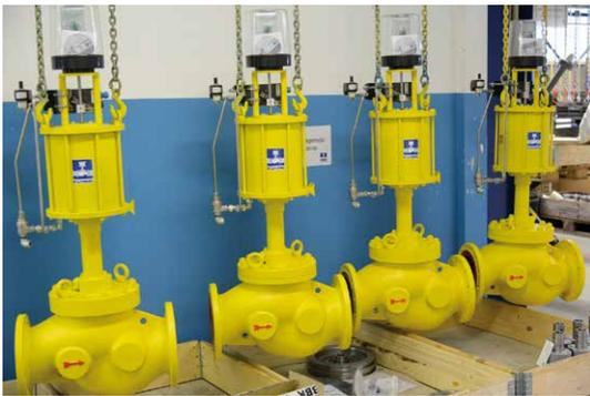
Abb. 6: Gas-Hybridventile
